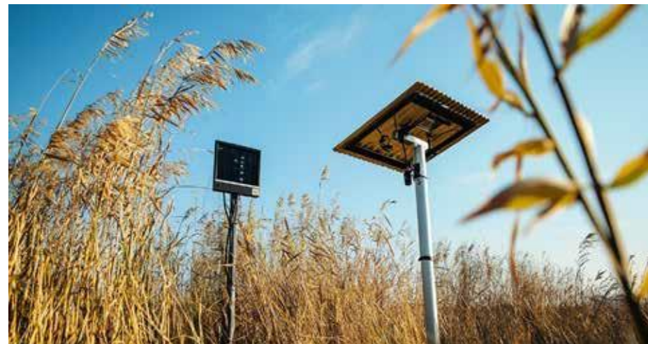
Ilustración 5.10 Vista del sensor acústico inteligente ubicado en la laguna, con sistema de carga solar, equipado con sensor de temperatura, cámara y capacidad de monitoreo remoto. Elaboración propia asistida por IA (Midjourney).
